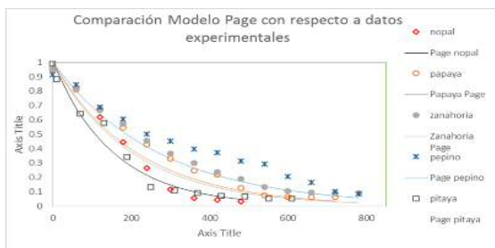
Figura 9. Correlación entre los datos experimentales y los obtenidos con el Modelo de Page
